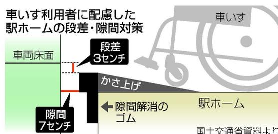
国交省は、2018年、車いす利用者による乗降車実験を実施。車両とホームが接触せず、利用者の約9割が、スムーズに乗り降りできた「段差3センチ、すき間7センチ」（コンクリート敷きの線路で直線ホームの場合）を目安値に設定しました。
