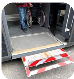
ミュンヘンの市電。電動でスロープが下りてくる。
