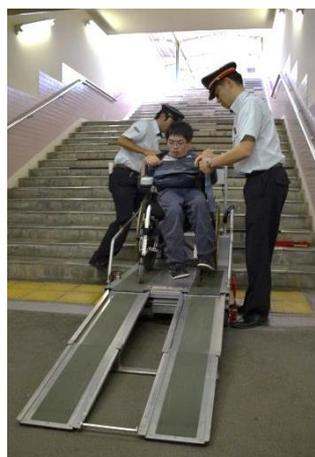
スロープが座面下に収められ、階段を上っていくと、座面は水平が保たれ、階段はカタピラで上っていきます。
