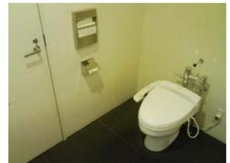
（入口：開き戸、幅 69 cm）中で回転ができました。トイレ前通路 L 字に折れる、幅約 85 cm～88 cm、トイレ便房内幅 118 cm×長さ 218 cm。便座前方から壁 160 cm。美術館 1 階には少し扉の重い、共用の車いす用トイレがあり、そちらも利用可。（入口：引き戸、幅 84 cm、手すり：両側固定、便器向かって左側が L 字手すり、右側は水平手すり）
