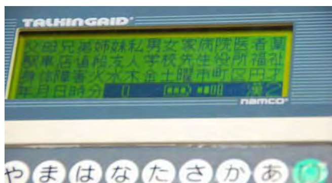
トーキングエイドの漢字モード＝五十音のひらがなキーを押すとそれに対応したキーを押すとその漢字が選択される
