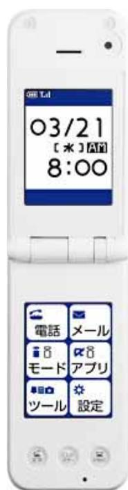
今回とりあげた2画面ユニバーサルデザイン携帯電話(FOMA D800iDS)は、後発になりますがゲーム感覚を生かしたタッチパネルを使用しています。2画面ユニバーサルデザイン携帯電話は、NTTドコモと三菱電機が共同で開発してきました。2007年2月に店頭で販売が始まり、一般の携帯電話と同じように並べられていますので「タッチパネルの製品」「FOMA D800iDS」で探すとよいでしょう。折りたたみ型で開くと2つの画面になります。通常下の画面にあるプッシュ式のテンキーが800iDSでは、タッチパネルのテンキーになります。
