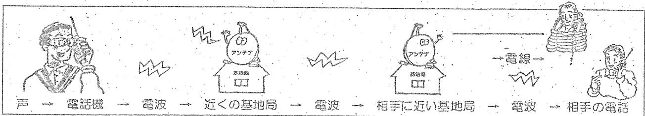
声を電波で送るので、コードが不要。室内外で使用可能。ただ、基地局（電波を受け、相手へ送る作業をする局）を作る費用が、電波の届く範囲を広くするために高く、加入者がまだ少ないので、以下の特徴がある。
